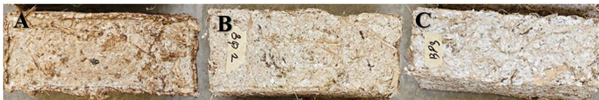
Figura 1. Muestras de briquetas de bagazo y aglutinante obtenidas mediante densificación a baja presión. A) Briquetas del tratamiento BAP1. B) Briquetas del tratamiento BAP2. C) Briquetas del tratamiento BAP3.
